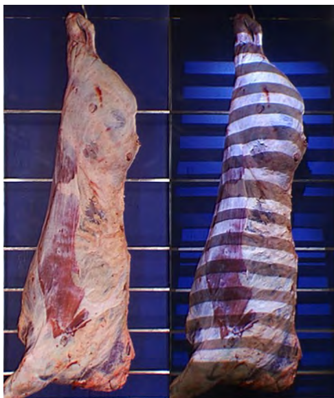
Figura 7.4. Imagem que ilustra a utilização de um sistema VIA com imagem bidimensional (esquerda) e imagem tridimensional com luz estruturada (direita) do sistema VBS 2000, adaptado de (17).
